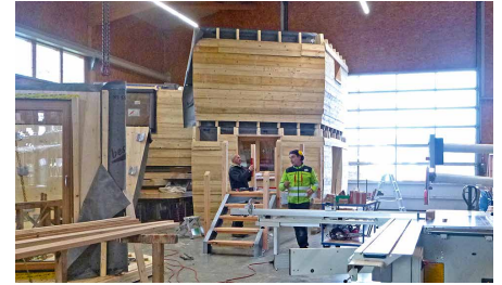
Blick in die Montagehalle: Vormontage der Gebäudemodule für die Erweiterung des Baumhaushotels Allgäu.
